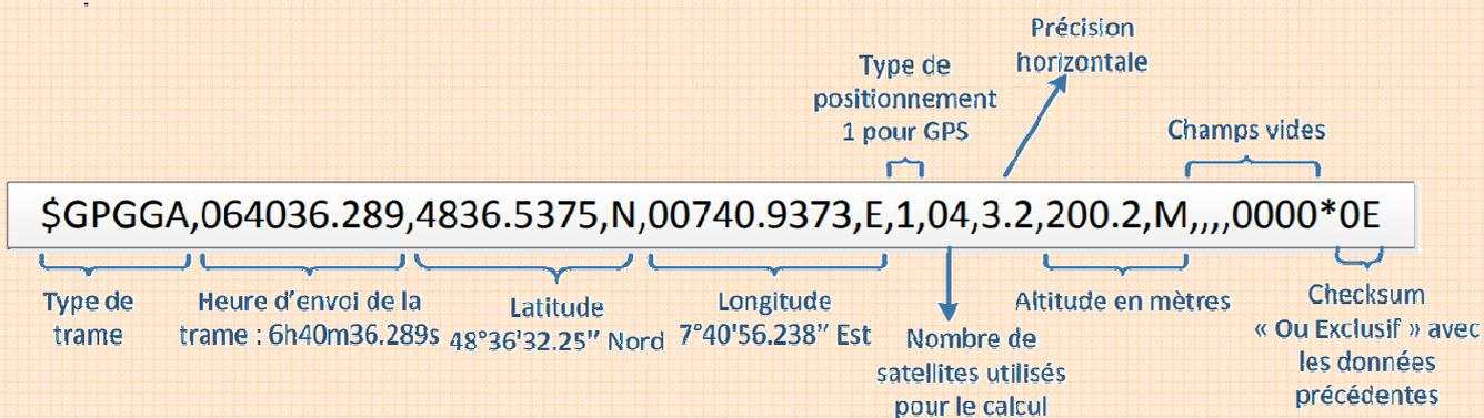
➤ **Les deux premiers caractères** après le signe \$ (talker id) identifient le réseau de satellites à l'origine du signal. Les principaux préfixes sont : **BD** ou **GB** pour Beidou ; **GA** pour Galileo ; **GP** pour GPS ; **GL** pour **GLONASS**. Les différents réseaux de satellites proposent un service de positionnement (Galileo pour les européens, GPS pour les américains, etc.).
